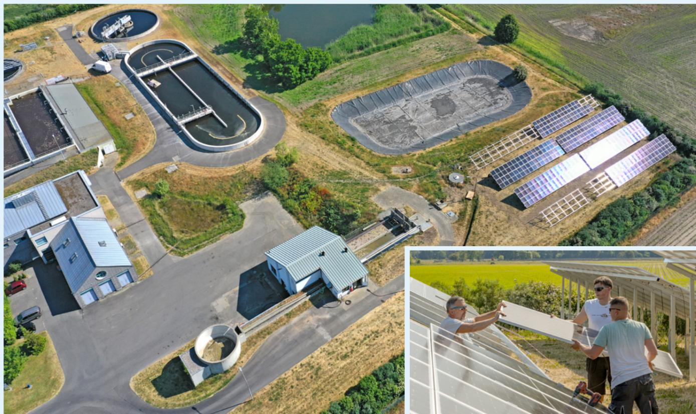
So soll es sein – und bleiben: Die Sonne „knallt“ auf die noch im Bau befindlichen Photovoltaik-Module. Die Bilder entstanden am 6. Juni. Die Anlage ging noch im Juni in den Probetrieb. Jährlich sollen hier etwa 100.000 kWh Strom für den Eigenbedarf erzeugt werden. Foto: SPREE-PR/Petsch
